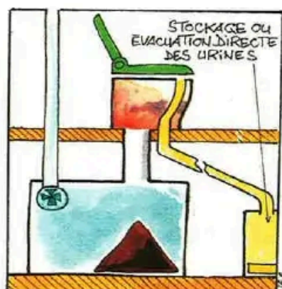
MODÈLE DISSOCIÉ AVEC SÉPARATION ET VENTILATEUR
